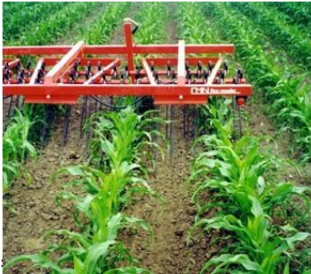
Billede 3. Langfingerharve med frødstyr. Frøene skal spredes foran tænderne på langfingerharven, så frøene harves ned og dækkes med jord. (Foto udlånt af CMN Maskintec A/S).
