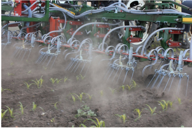
Billede 2. Radrenser med frødstyr og efterharve. Frøene skal spredes efter tænderne på radrenseren, men før efterharven, så frøene harves ned i jorden. (Foto: Poul Henning Pedersen, VFL).
